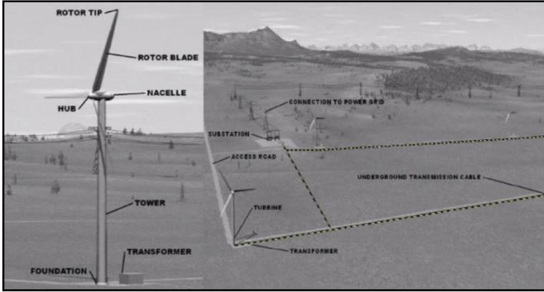
الشكل 4: (أ) المكونات الهيكلية القياسية لتوربين الرياح. (ب) المكونات القياسية لمزرعة الرياح.
